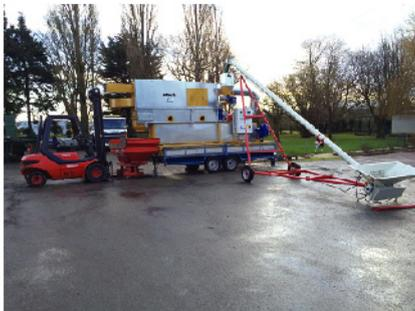
➤ Ce type d'appareil, destiné aux agriculteurs ou transformateurs, permet de diminuer la dépendance protéique et favorise l'auto consommation des céréales et autres graines produites sur l'exploitation. Son débit varie de 1 Tonne à 2.5 Tonnes par heure en fonction de la graine.
